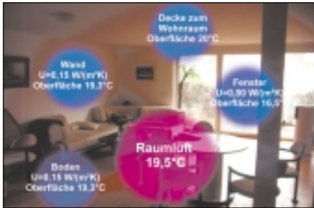
24 Hohe Behaglichkeit und ausgeglichene Temperaturen bei guter Wärmedämmung
